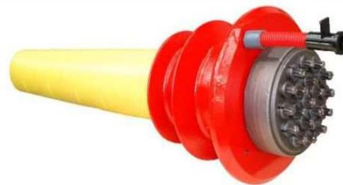
L'ancoraggio è composto da una piastra, morsetti, raccordo e fusione. La fusione è protetta con vernice in epossipoliesteri, tale da garantire all'ancoraggio un'adeguata protezione alla corrosione; inoltre l'ancoraggio "MEep<sup>®</sup>" è dotato di un CAP di chiusura che garantisce la protezione del piattello. La protezione con vernice può essere fornita con diversi livelli: "MEep<sup>®</sup> I", "MEep<sup>®</sup> II" e "MEep<sup>®</sup> III".
