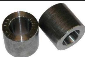
Le **bussole coniche T15**, marcate sulla parte superiore e realizzate in acciaio **C40-45 UNI EN 10083/1**, sono utilizzate su ancoraggi TTRE con trefoli 15,2 - 15,7 mm.
