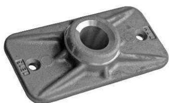
Piastrina forgiata in acciaio **C40-45 UNI EN 10083/1** realizzata per applicazioni con trefoli T15, T15S e T15C; sulla parte superiore è lavorata meccanicamente per consentire il fissaggio del CAP di protezione.
