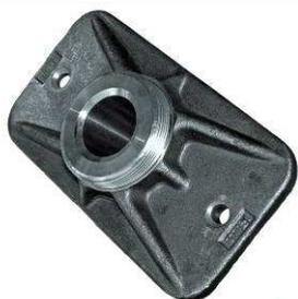
Piastrina forgiata in acciaio **C40-45 UNI EN 10083/1** per applicazioni con trefoli T15, T15S e T15C; sulla parte superiore è lavorata meccanicamente per consentire il fissaggio del CAP filettato.
