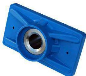
Piastrina forgiata in acciaio **C40-45 UNI EN 10083/1** e ricoperta di polietilene; è realizzata per applicazioni con trefoli T15, T15S e T15C. Il CAP di protezione è fissato a pressione.
