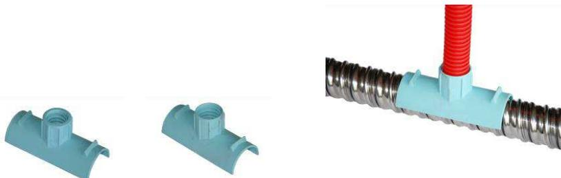
Il posizionamento degli sfiati sulla guaine corrugate permette di garantire la corretta fuoriuscita dell'aria dai condotti durante l'iniezione. Va installato in tutti i punti del cavo, dove possa verificarsi una sacca d'aria durante l'iniezione. La calottina tipo **DD-1001** è realizzata con materiale morbido tale da permettere l'abbinamento con tutte le misure di guaina.
