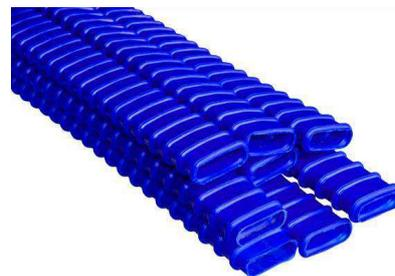
Le guaine in polietilene della serie **SPE** sono realizzate secondo le specifiche FIB in HDPE estruso, in barre con lunghezza variabile compresa tra 5,8 e 11,8 metri; sono realizzate di colore Blu e per la loro giunzione è utilizzato un manicotto termo restringente.
