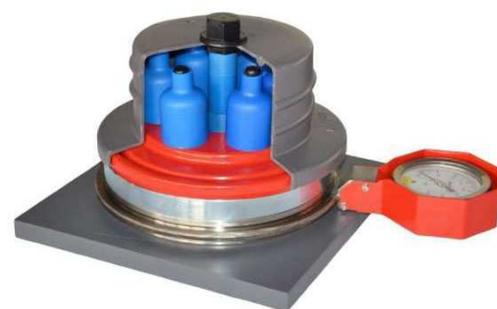
Sigillare con silicone la zona compresa tra CAP di protezione e cella di carico.
