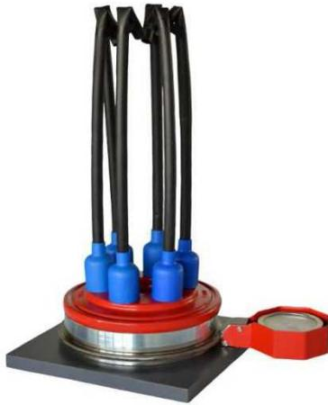
Ancoraggio TTR-E dotato di cella di carico tipo **DI** applicata su tirante provvisorio fornito di protezioni elementari di tipo lungo. Ancoraggio ritesabile.
