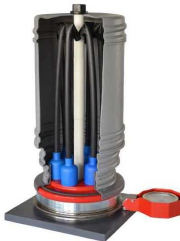
Ancoraggio TTR-E dotato di cella di carico tipo **DI** applicata su tirante provvisorio o permanente fornito di protezioni elementari e CAP di tipo lungo. Ancoraggio ritesabile.
