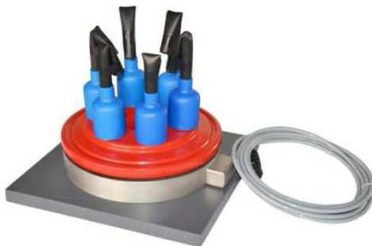
Ancoraggio TTR-E dotato di cella di carico tipo **DE-S** applicata su tirante provvisorio dotato di protezioni elementari. Ancoraggio non ritesabile.
