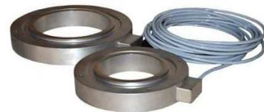
Le celle sottoposte a un carico subiscono una deformazione rilevata dagli estensimetri, i quali variando il loro valore di resistenza, generano un segnale elettrico proporzionale al carico applicato.
