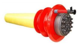
L'ancrage est composé de: plaque d'ancrage, étaux, raccord et fusion d'ancrage. La fusion d'ancrage est protégée par une peinture époxy polyester, afin de garantir à l'ancrage une protection adéquate contre la corrosion; l'ancrage "Mep<sup>®</sup>" est aussi équipé d'un capot de fermeture qui garantit la protection de la plaque d'ancrage. La protection par peinture peut être fournie avec de différents niveaux de protection : "Mep<sup>®</sup>I", "Me<sup>®</sup>II" et "Mep<sup>®</sup>III"
