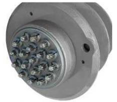
Ancrage **ME<sup>L</sup>** en protection **L** de **post-tension externe adhérente**, composé de fusion noyée dans le béton, ancrage complet d'étaux, raccord en acier peint, capot de protection injecté de ciment, étaux et utilisation de toron nu. Le capot de protection permet de protéger l'ancrage avec un remplissage de ciment. Cette application est la plus simple parmi les applications remplaçables dans le temps.
