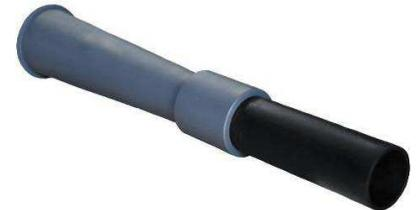
Le raccord interne, équipé d'un déflecteur, est en acier et le tube en polyéthylène pour contenir les torons est fixé par filetage.
