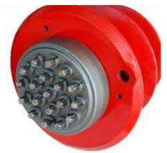
Ancrage MEep<sup>N</sup><sup>®</sup> en protection N de **post tension externe adhérente**, composé de fusion protégée par peinture époxy noyée dans le béton, plaque d'ancrage complète d'étaux, raccord en acier protégé par une peinture époxy, capot de protection injecté de ciment, étaux et utilisation de toron nu. Le capot de protection permet de protéger l'ancrage avec un remplissage de ciment. L'ancrage peut être remplacé dans le temps si nécessaire.
