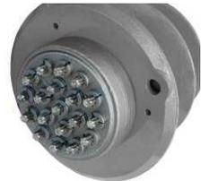
Ancrage **ME<sup>M</sup>** en protection **M** de **post-tension externe non adhérente**, composé de fusion noyée dans le béton, plaque d'ancrage complète d'étaux, raccord en acier peint, capot de protection injecté de ciment, étaux et utilisation de toron nu. Le capot de protection permet de protéger l'ancrage avec un remplissage de ciment. L'ancrage peut être remplacé dans le temps si nécessaire.
