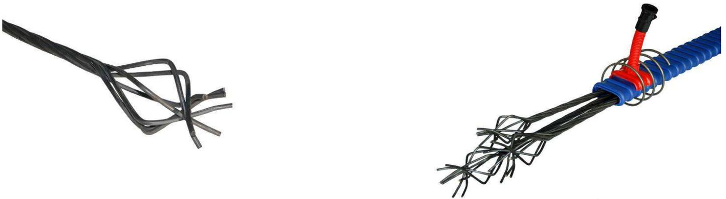
Les ancrages passifs série S ont été réalisés dans le plein respect des réglementations en vigueur. Dans ce type d'ancrages, les torons près de l'extrémité sont ouverts afin d'améliorer l'adhérence au béton.
