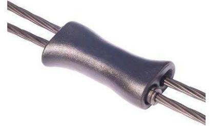
Le joint F est réalisé pour le cerclage de réservoirs ou pour le positionnement en caisses comme jonction de deux torons qui peut être tendue. L'ancrage est généralement utilisé comme ancrage actif non adhérent et employé avec des torons graissés et gainés en Vipla.
