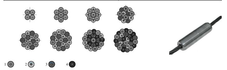
Les joints série "G" adhérents sont réalisés pour permettre la jonction des câbles pendant la construction de: ponts à l'avancement, joints d'injection et reprise des câbles. L'accouplement est réalisé par des manchons monotoron équipés à leur intérieur d'étaux préchargés avec un dispositif à ressort.
