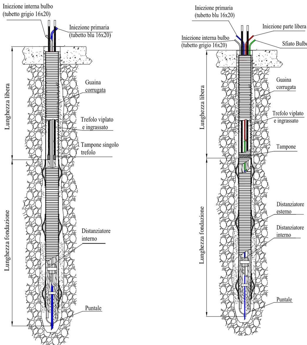
Il tirante **TPE-02A** è dotato di guaina corrugata su tutta la lunghezza. L'iniezione è realizzata con due tubetti: iniezione primaria e iniezione interna. Questa versione è predisposta per l'aggancio della protezione totale ed è dotata di tamponi eseguiti su trefolo tra parte libera e fondazione.
