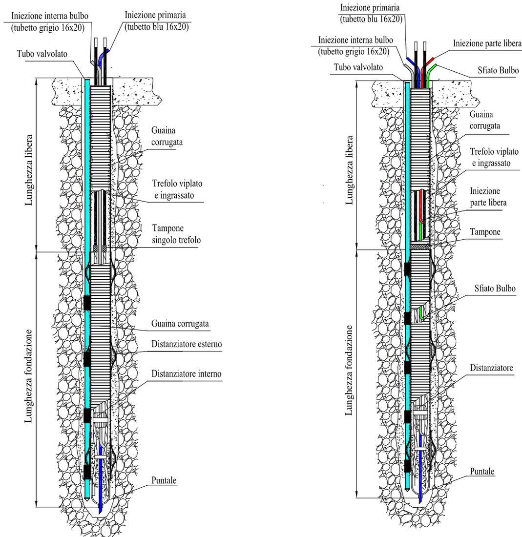
Il tirante **TPE-02SPA** è dotato di guaina corrugata su tutta la lunghezza. L'iniezione è realizzata con due tubetti: iniezione primaria e iniezione interna. Questa versione è predisposta per l'aggancio della protezione totale ed è dotata di tamponi eseguiti su singolo trefolo tra parte libera e fondazione.
