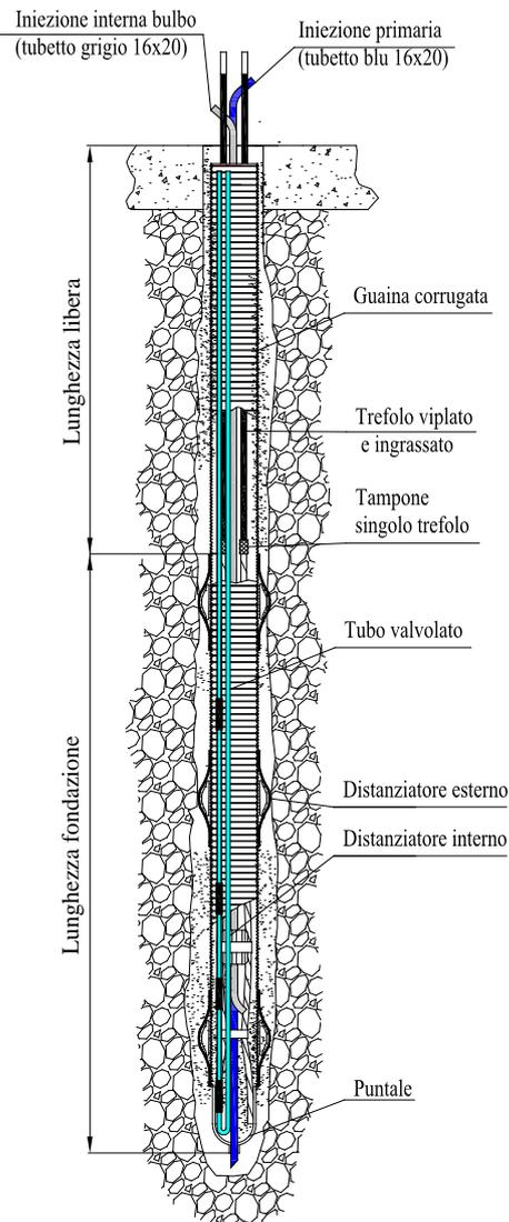
Il tirante **TPE-08A** è dotato di guaina corrugata su tutta la lunghezza. L'iniezione è realizzata con due tubetti: iniezione primaria e iniezione interna. Questa versione è predisposta per l'aggancio della protezione sotto piastra ed è dotata di tamponi eseguiti su singolo trefolo tra parte libera e fondazione. Sull'esterno del tirante permanente è installato un tubo valvolato ad U 15x21 mm, tale da permettere l'iniezione ripetuta I.R.
