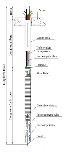
Tirante permanente **TPH4** dotato di guaina corrugata sul tratto di fondazione, guaina liscia nella parte libera e di un tampone unico eseguito tra parte libera e fondazione. Le iniezioni primaria, fondazione e parte libera sono realizzate con tre tubetti.
